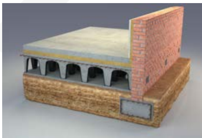
Ventilación mismo nivel Sección passive house
